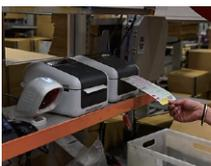
ピッキング後、出荷商品は検品・梱包ラインへ。バーコード・スキャンによる検品を行い、その後2台のTD-4420DNから必要な運送会社の送り状と検品明細を印刷します。
