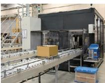
自動封かん機「e-Cube」は、段ボール箱内の商品の高さを自動で認識し、最小サイズで自動梱包する最新の設備です。これにより作業効率化と運送費削減を実現しています。
