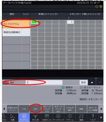
PLCプログラムを選択した状態で「1」を入力後に 「出力」を押すとUSBにラダープログラムが出力されます。
