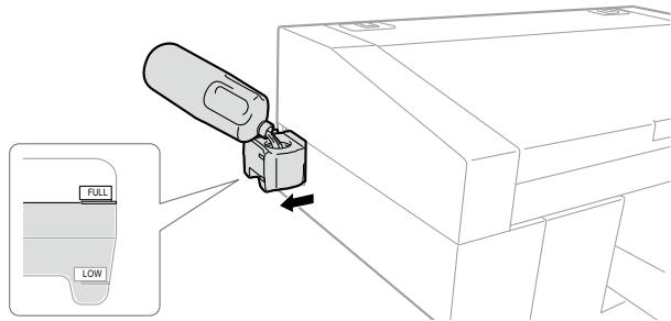
洗浄液タンクをプリンターの側面から引き出したふたを開け、洗浄液を「FULL」の線まで注ぎます。
