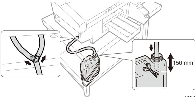
廃液チューブを本体に差しこみ、廃インクタンクをテーブルの脚等に 2 本のひも等で固定し、廃液チューブを廃インクタンクに差し込む
