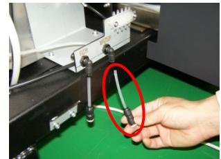
※接続口径 4mm のチューブを使用するときは外す。
