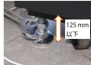
脚（4箇所）を固定している下側のナットを回転させ、水平を調整する
