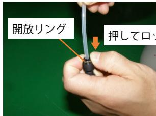
開放リングを押してロックを解除し、チューブを抜く
