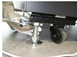
水平が調整できたら上側のナットを上に向かって締める
