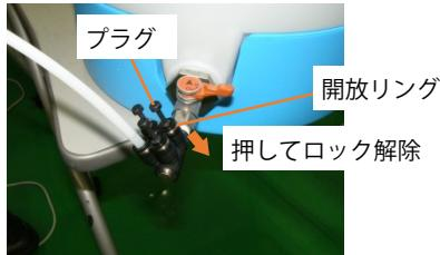
開放リングを押してロックを解除し、プラグを抜く
