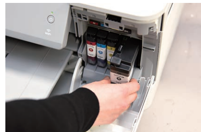
手が汚れにくい構造のインクカートリッジ交換。
