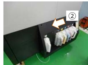
②の方向にしっかり差し込み、仮付けしたメインタンクカバー取り付けねじ (M4) 2本と緩めたねじ4本を締める
