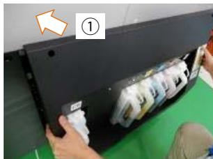
タンクのキャップに付属のバンドが手前に向くように向きを揃え、メインタンクカバーを持ち上げ、タンクのキャップを越えるまで①の方向にスライドさせる
