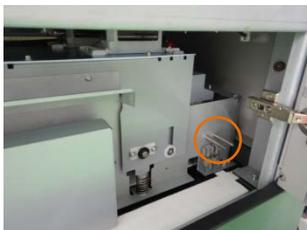
同梱のカム固定ピンをメンテナンスユニットへ取り付けて保管し、扉を閉じる
