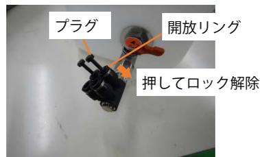
開放リングを押してロックを解除し、プラグを抜く
