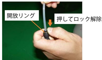
開放リングを押してロックを解除し、チューブを抜く
