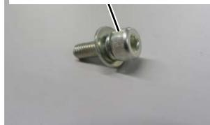
本体下側からプリントスイッチユニット取り付けねじ4本で固定する（トルク：2.0 N・m）
