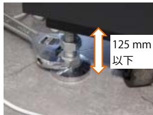
脚（4箇所）を固定している下側のナットを回転させ、水平を調整する
