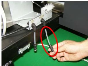
※接続口径 4mm のチューブを使用するときは外す。
