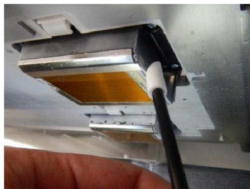
(10) キャリッジ下面に、ノズル面から突出しているインクの固まりがある場合は、除去してください。
