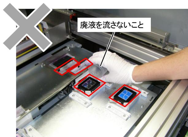
(7) クリーンスティック R で、プリントヘッドのノズル面を掃除します。
