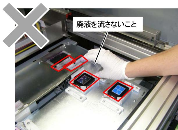
(6) クリーンスティック R で、プリントヘッドのノズル面の周辺を掃除します。
