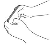
2 ベースフィルムガイドにベースフィルムを差し込みます。 ベースフィルムの切り欠き部分が右上になるように差し込んでください。
