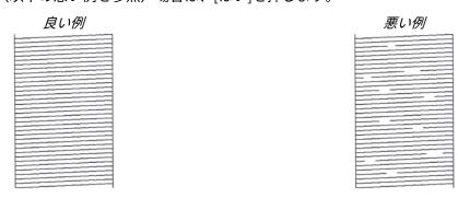
6 タッチパネルの画面に、各色の印刷品質を確認するように促すメッセージが表示されたら、印刷結果にもっとも近いパターンの番号(1~4)を押します。
