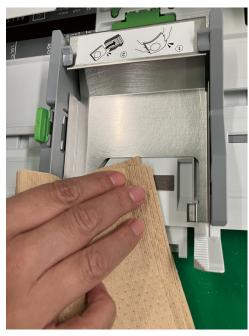
5 トレイ1を印刷機構にゆっくりと差し込み矢印の位置で一度止めます。
