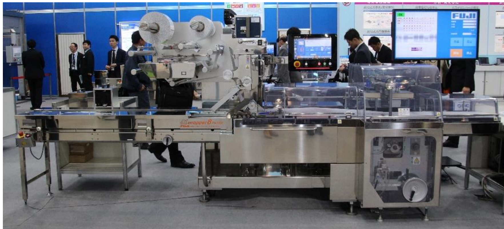
JAPAN PACK 2019にて展示されたフジカイ製 高速横形ピロー包装機（中央上部にVx3-A）
