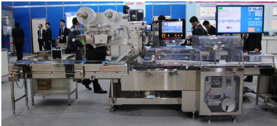
JAPAN PACK 2019にて展示されたフジキカイ製 高速横形ピロー包装機（中央上部にVx3-A）
